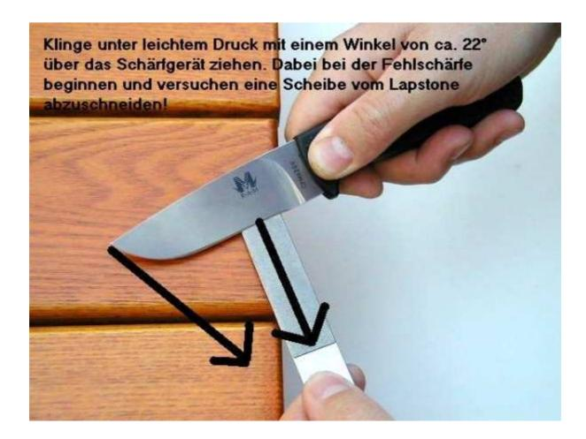
So lange schärfen, bis eine Klingenseite einen durchgehenden Grat aufweist. Dann die feine Seite des Lapstones benutzen und wie vorher verfahren. Der Grat sollte zum Schluß mit einem etwas stumpferen Winkel mittels der feinen Seite unter Anwendung von ganz wenig Druck entfernt werden.
